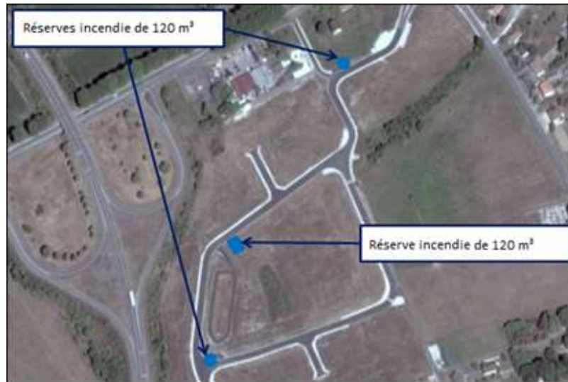
Fig. 1. Emplacement des poteaux incendie et de la réserve d'eau incendie
