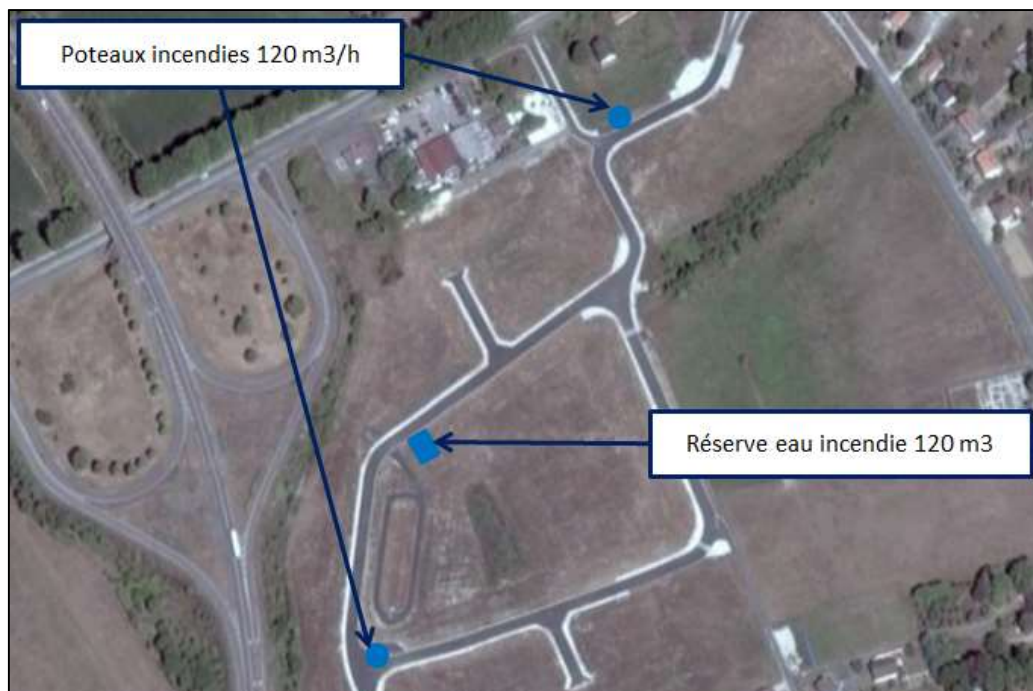
Fig. 4. Emplacement des poteaux incendie et de la réserve d'eau incendie
